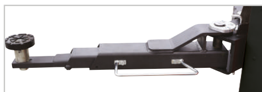
Arresto bracci a inserimento automatico e sgancio automatico a terra
